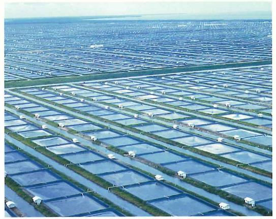
DCD社の養殖場を空撮。家が並んでいる側の水路が排水路で、そうでない方が海水の取水路。ひと家族がふた池を管理する。
